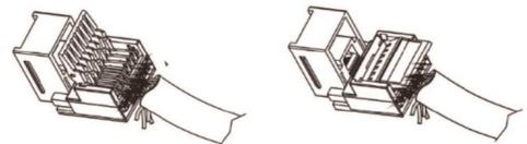
步骤二: 再次打开压线盖, 将剩下的四根网线按照对应色标颜色插入卡线槽中, 按下压线盖, 压紧
