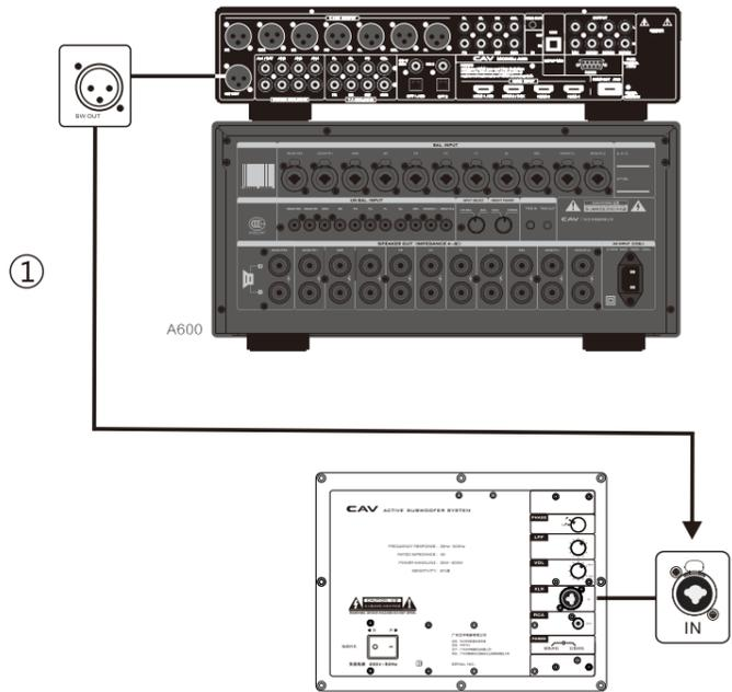
① XLR 接口，平衡信号输入接口，适合前级解码器SW信号的远距离信号传输；
